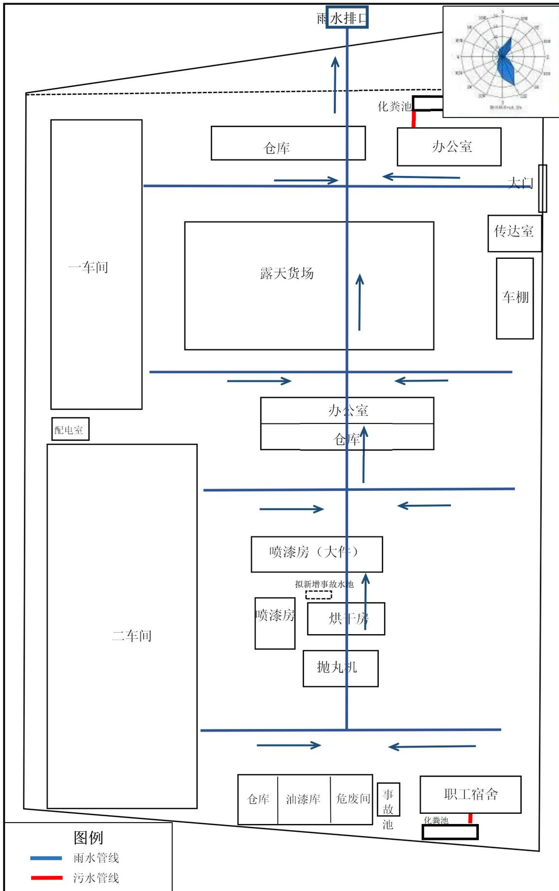
附图 9 企业雨水和污水管网图 (1:820)
